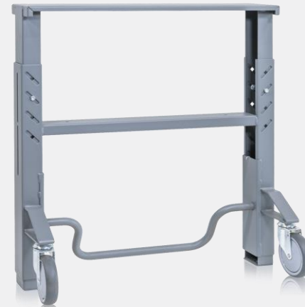
1-179-136 Hjulbenbock HD 500. Låses lätt med fotbygeln. Hjulen är 125 mm i diameter, svängbara med TPE-bana. Maximal belastning på bordet är 500 kg fördelad vikt.
